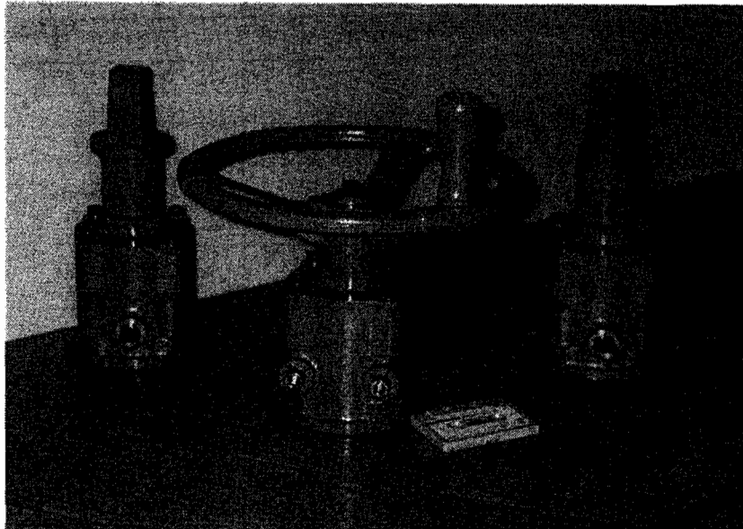
セルフロック インライン減速機の例
